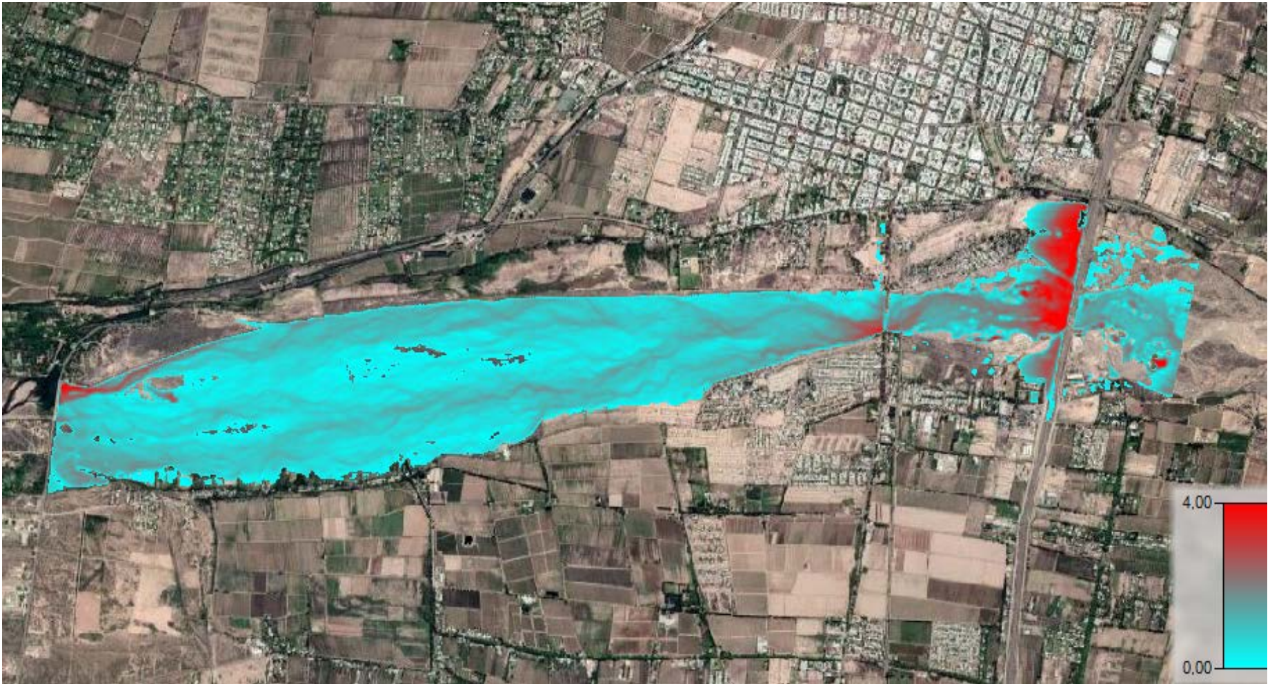
Ilustración 6: Resultados de Modelación Bidimensional Q = 1.800 \text{ m}^3/\text{s} . Mapa de Tirantes Máximos en (m)
